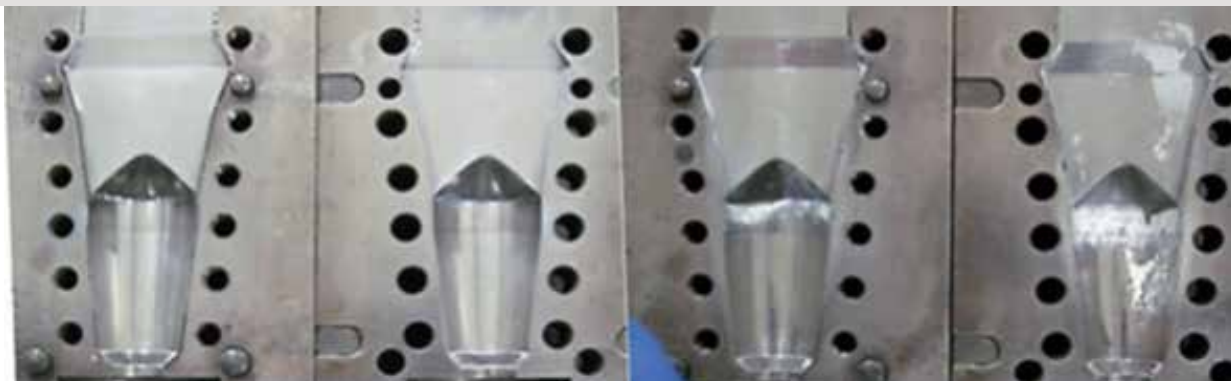
شکل ۱- نمونه‌هایی از پلیت اوت سمت چپ (کمترین رسوب) و راست (بیشترین رسوب) را نشان می‌دهد.
