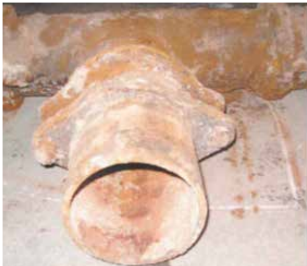
شکل ۵: خط اصلی آب در مناطقی که نیاز به جایگزینی دارد، خوردگی هر دو بخش بیرونی و داخلی لوله ها نشان داده شده است. (باتیچر و همکاران [۶])
